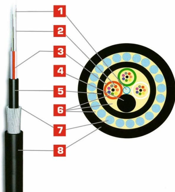
1. Центральный силовой элемент (ЦСЭ) стеклопластиковый пруток (стальной канат) в полимерном покрытии или без него.
