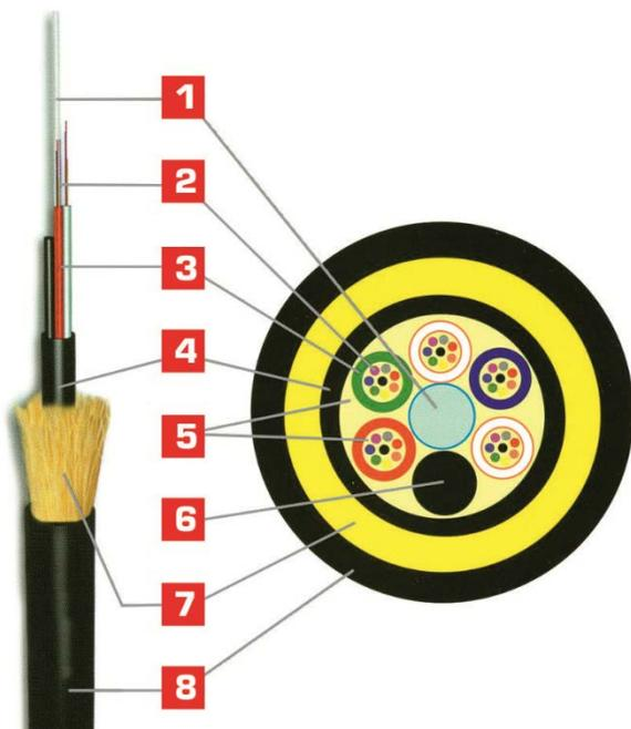
1. Центральный силовой элемент (ЦСЭ) стеклопластиковый пруток (стальной канат) в полимерном покрытии или без него.
